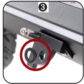
Maintenant, faites glisser la béquille latérale **4** sur l'ouverture et serrez bien la vis avec une clé de 17 **5** - **6**.
