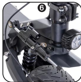
Enfin, réglez le guidon à fond vers la gauche, puis serrez fermement la vis de réglage **9**. La force peut maintenant être réglée sur la molette de réglage située au-dessus de l'amortisseur de direction.
