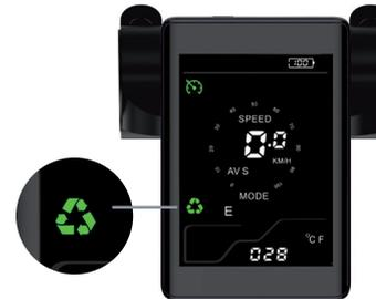
La consommation d'énergie est idéale. La puissance maximale est inférieure à 80% de la capacité lorsque la vitesse est inférieure à 10 km/h. La puissance maximale est inférieure à 20% de la capacité lorsque la vitesse est supérieure à 10 km/h.
